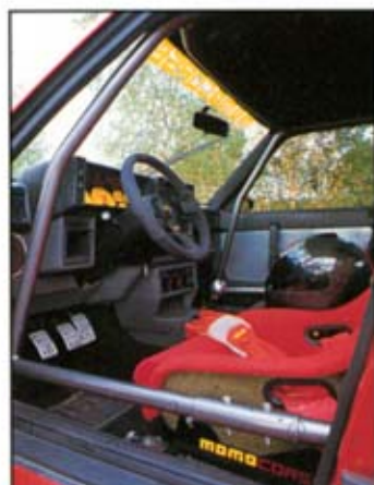
ORDENTLIGT LÄTTAD. Ska det vara racestuk så måste man satsa. Stolarna i kolfiber/kevlar väger bara 5,5 kg styck. En skyddsbur var nödvändig för att få pluspoäng i listan.
