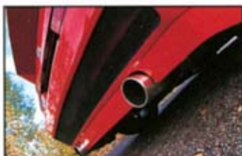
FYRA TUM ÄR MINIMUM! För att få en riktigt fräckt bakparti på Alfa byggde man ett fungerande luftutsläpp i bakspoilern. Slutrören mäter 114 mm diameter vardera!
